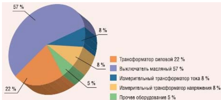
Рис. 3. Технологические нарушения маслонаполненного оборудования
