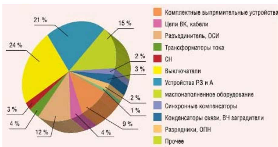
Рис. 2. Технологические нарушения на подстанциях по видам оборудования
